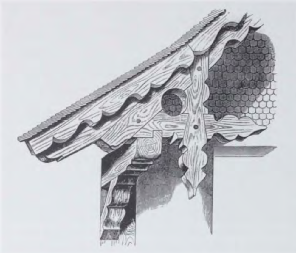
29. Ernst Georg Gladbach, Konstruktion eines Flugsparrendreiecks und eines Aufschieblings, 1868
