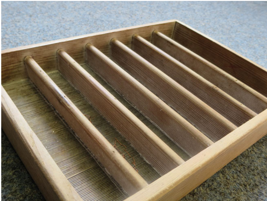
Abb. 5 u. 6: Vorder- und Rückansicht einer Schöpfform mit Deckel und Stegen, Format DIN A 4, moderne Nachbildung aus der Werkstatt von Johannes Follmer, Foto: Sandra Schultz 2015.
