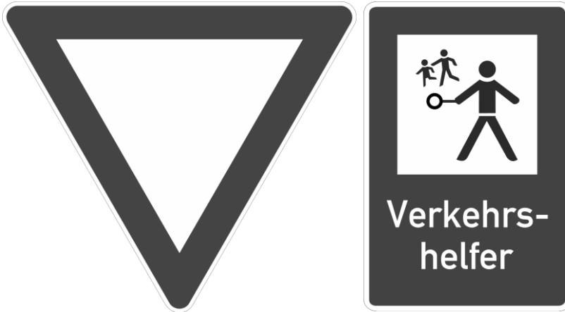
Abbildung 5.1: Beispiel für Komplexität zweier Symbole, dargestellt in Graustufen, wie dies für einen Projektionsscheinwerfer möglich wäre. Links: Zeichen 205 StVO („Vorfahrt gewähren“). Rechts: Zeichen 356 StVO („Verkehrshelfer“).
