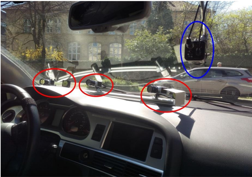
Abbildung 4.26: Eye-Tracking-System im Versuchsfahrzeug. Auf dem Armaturenbrett die drei Tracking-Kameras sowie die beiden Infrarotstrahler (rot markiert). Hinter der Windschutzscheibe ist die Szenenkamera montiert (blau markiert). Die Kartonagen dienen der Abschattung der Infrarotlichter vor der Szenenkamera.
