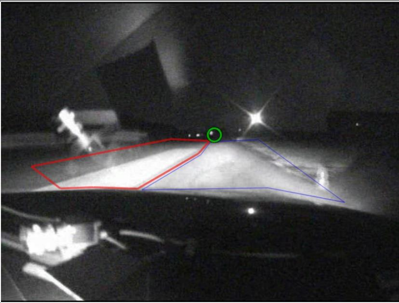
Abbildung 4.28: Screenshot aus MAPPs . In rot die ROI „linke Fahrbahn“, in blau die ROI „eigene Fahrbahn“. Der grüne Kreis ist die momentane Blickrichtung. Die scheinbare Blendquelle oberhalb der eigenen Fahrbahn ist lediglich Wärmestrahlung die von der IR-empfindlichen Szenenkamera, nicht jedoch vom Auge erfasst wird.
