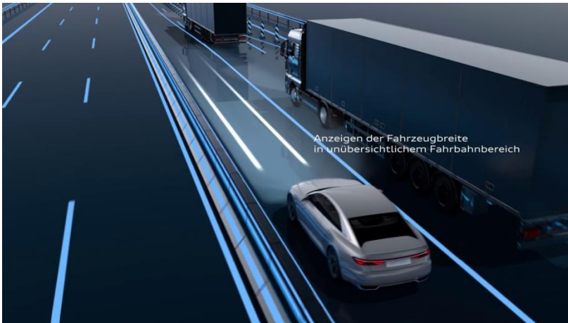
Abbildung 1.1: Konzept des Baustellenlichtes von Audi, welches dem Fahrzeugführer die Breite seines Fahrzeuges mittels zweier projizierter Linien anzeigt [AUD15].
