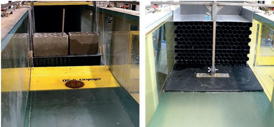
Abbildung 2.5 Strömungsgleichrichter im ersten Untersuchungsabschnitt (Ritsch 2016) (links; mit Betonziegel beschwert) und im zweiten Untersuchungsabschnitt (Gössel 2016)
