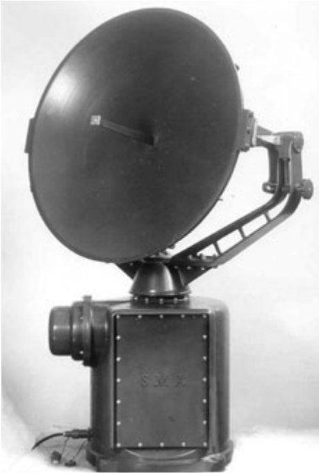
Figura 10. Selex Galileo (SMA) – Gruppo Antenna del radar CFL-3 (anni '50; pubblicata per cortese concessione di Selex Galileo).
