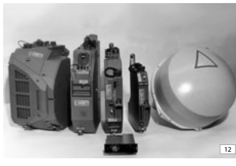
Figura 11. Selex Galileo (SMA) Radar Anticollisione per Autovettura sviluppato in collaborazione con il Centro Ricerche FIAT(anni '80; per cortese concessione di Selex Galileo).
