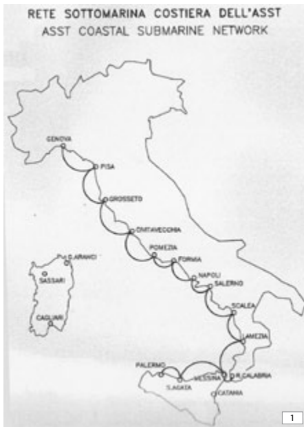
Figura 1. La rete sottomarina “a festoni” dell’ASST. Figura 2. Trasmettitore e ricevitore a 565 Mbit/s della rete “a festoni”.
