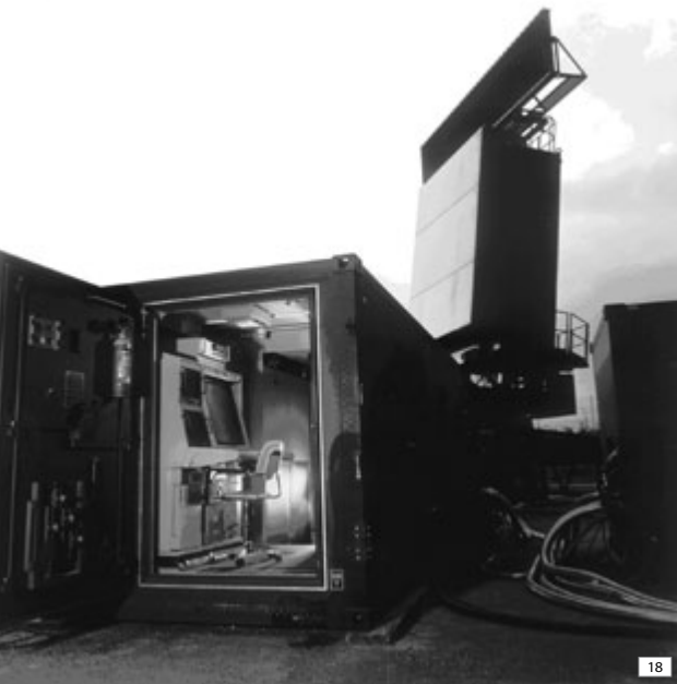
Figura 17. Il radar di tiro navale monopulse coerente RTN 30 X (per cortese concessione di Selex Sistemi Integrati). Figura 18. Il radar di avvistamento terrestre tridimensionale RAT 31 SL (per cortese concessione di Selex Sistemi Integrati).
