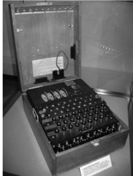
Figura 1. La macchina crittografica "Enigma" a 4 rotori era l'apparato utilizzato dalle forze armate tedesche durante la Seconda Guerra Mondiale per la trasmissione in codice di documenti segreti.
