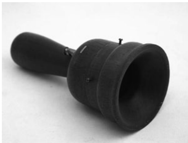
Figura 3. Il modello di telefono di Antonio Meucci fatto ricostruire da Marconi presso le Officine Galileo di Firenze conservato presso il Museo della Tecnica Elettrica di Pavia.
