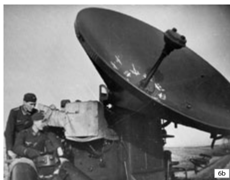
Figura 6. Il radar tedesco Würzburg in due versioni (a) e (b); si tratta del primo radar con la precisione sufficiente alla batterie contraeree di colpire un bersaglio in assenza di visibilità ottica.
