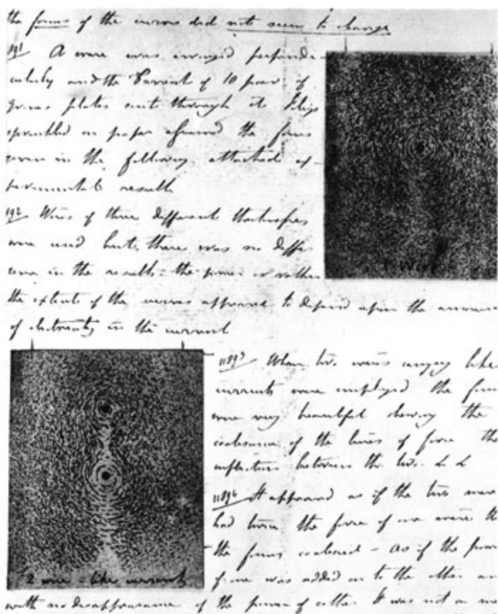
Figura 8. Pagina del diario di laboratorio di Faraday: linee di forza magnetiche tracciate con limatura di ferro.
