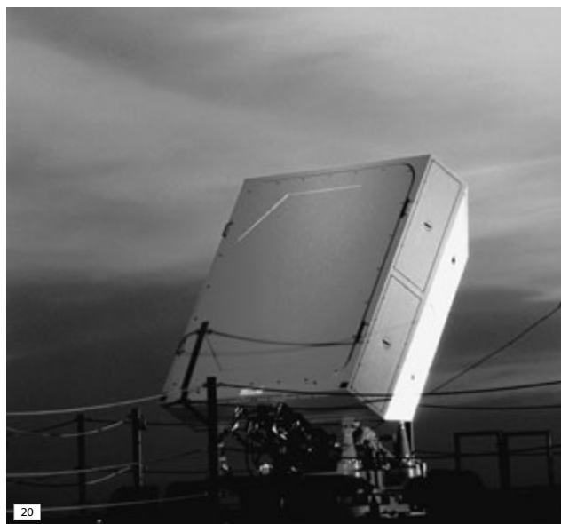
Figura 19. Il radar di avvistamento terrestre tridimensionale RAT 31 DL (per cortese concessione di Selex Sistemi Integrati).
