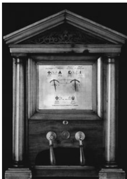
Figura 6. Telegrafo Wheatstone a due aghi adottato nel Regno di Sardegna.
