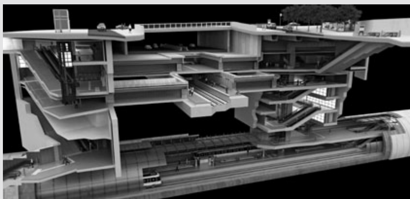
C. Ricostruzione virtuale delle interconnessioni sotterranee relative al prolungamento della Linea 5 della metropolitana di Barcellona (a cura della società Dortoka Disseny).
