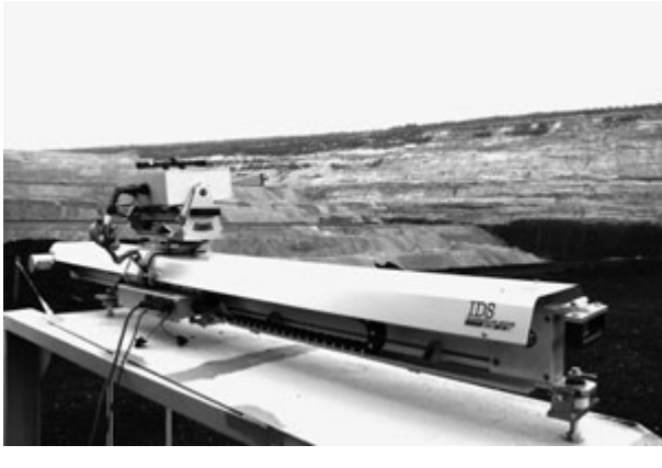
Figura 31. Radar interferometrico ad apertura sintetica IBIS della IDS (per gentile concessione della IDS SpA).
