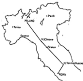
Figura 1. Tracciato del ponte radio Milano-Roma.
