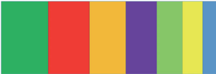
Aufgewickelte Rolle – Die Wicklungsbreite (=Umfang der einzelnen Kreise) nimmt von links nach rechts (=von außen nach innen) konstant ab (um 2\pi \cdot Wicklungsdicke)
