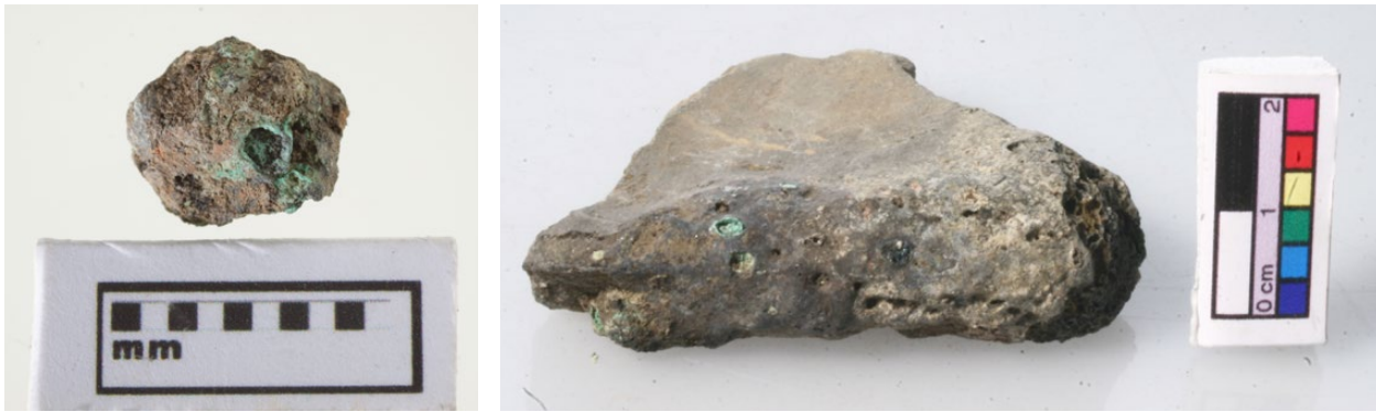
Figure 4. a) Belovode slag (sample 134); b) Belovode slagged sherd (sample 31b)
