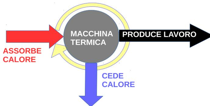
Figura 1.8: Principio di funzionamento di una macchina termica.
