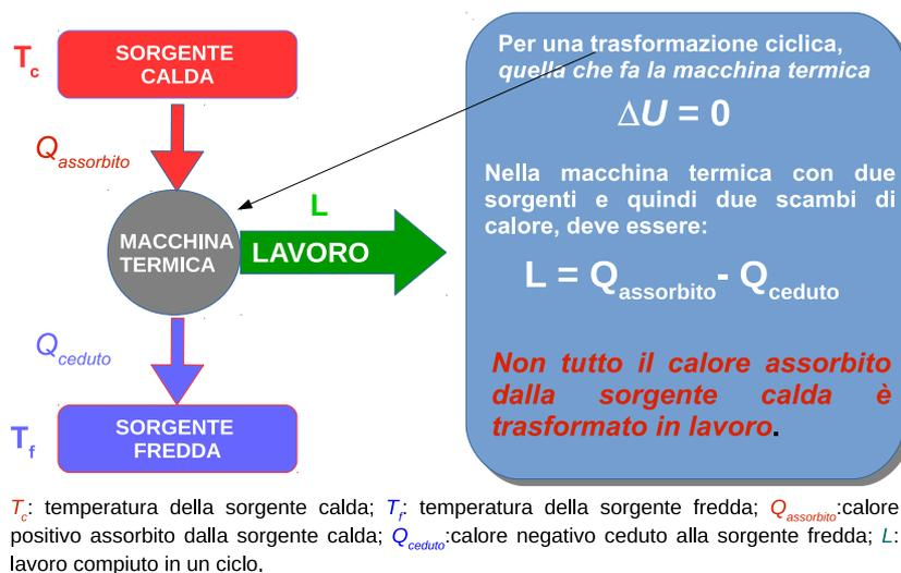
Figura 1.9: Scambio di calore una macchina termica.
