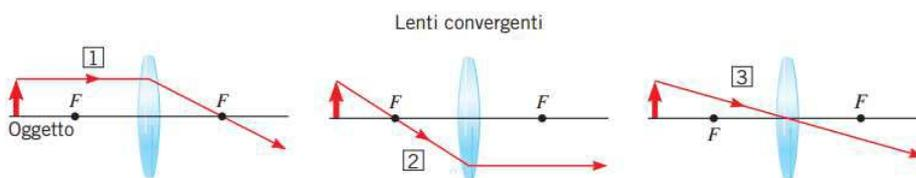
Figura 2.2: Costruzione del diagramma dei raggi per una lente convergente.
