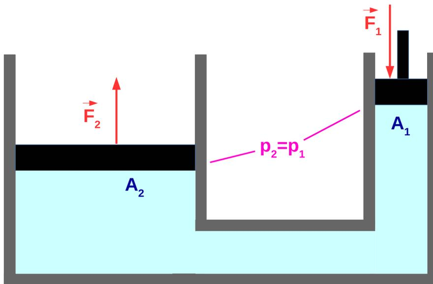
Figura 1.2: La leva idraulica.
