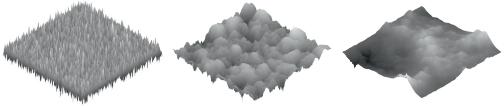
(a) S_{ZZ}(\omega) aus Gleichung (2.6) mit \omega_r = 80\pi \text{ mm}^{-1} (b) S_{ZZ}(\omega) aus Gleichung (2.6) mit \omega_r = 8\pi \text{ mm}^{-1} (c) S_{ZZ}(\omega) aus Gleichung (2.6) mit \omega_r = 0.8\pi \text{ mm}^{-1}
