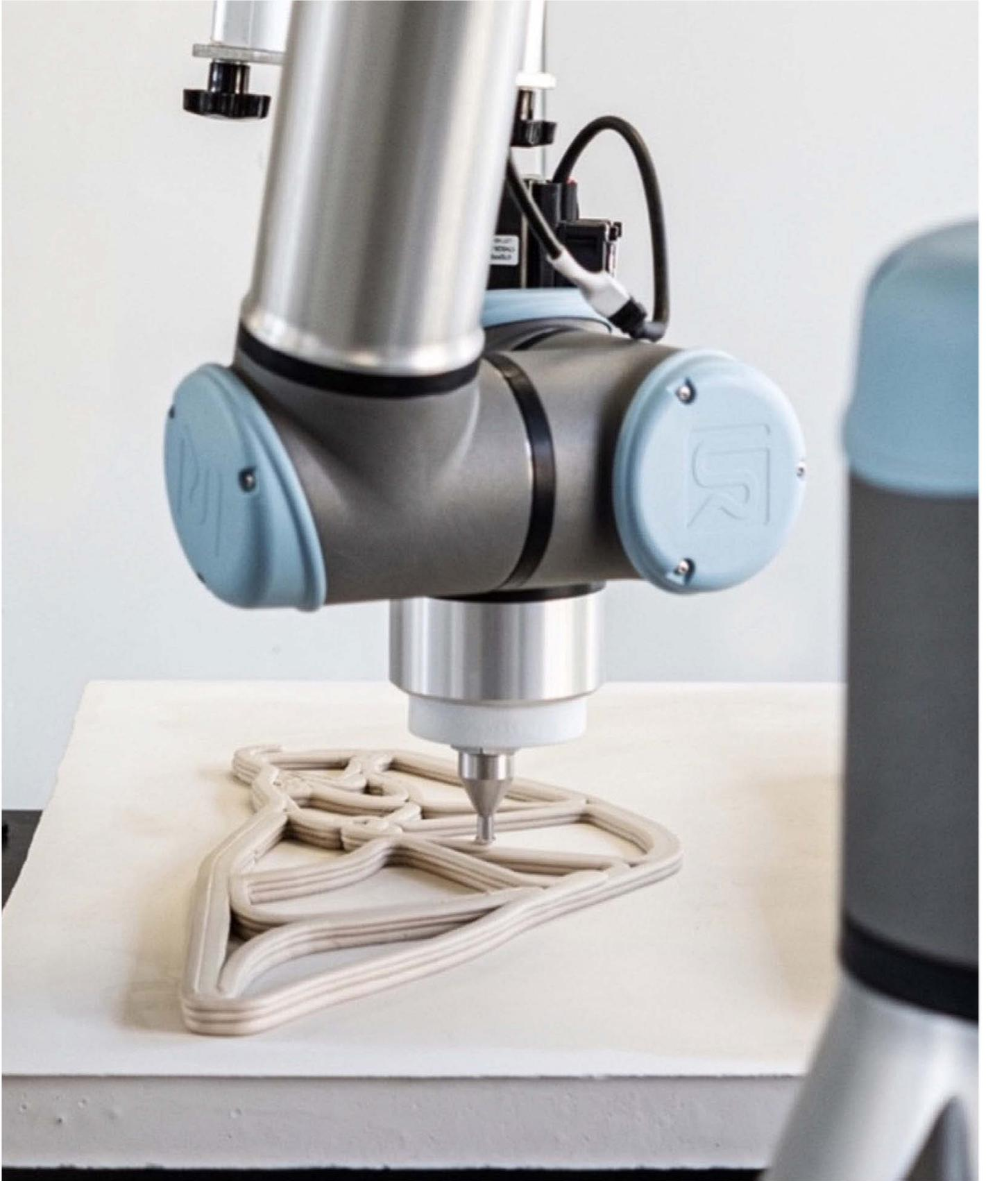
Abb. 2: Robotergestützte additive Fertigung von nicht standardisierten Porzellanstrukturen.
