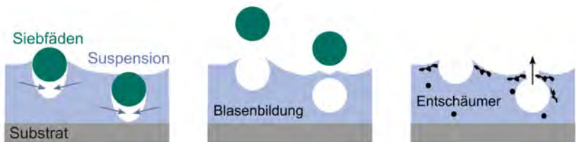
Abbildung 5.16: Entstehung von Hohlräumen unter den Siebfäden während des Siebabsprunges
