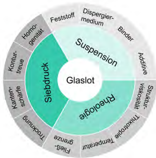
Abbildung 2.1: Schematische Darstellung einiger Einflussfaktoren für die Suspension, die Rheologie und den Siebdruck
