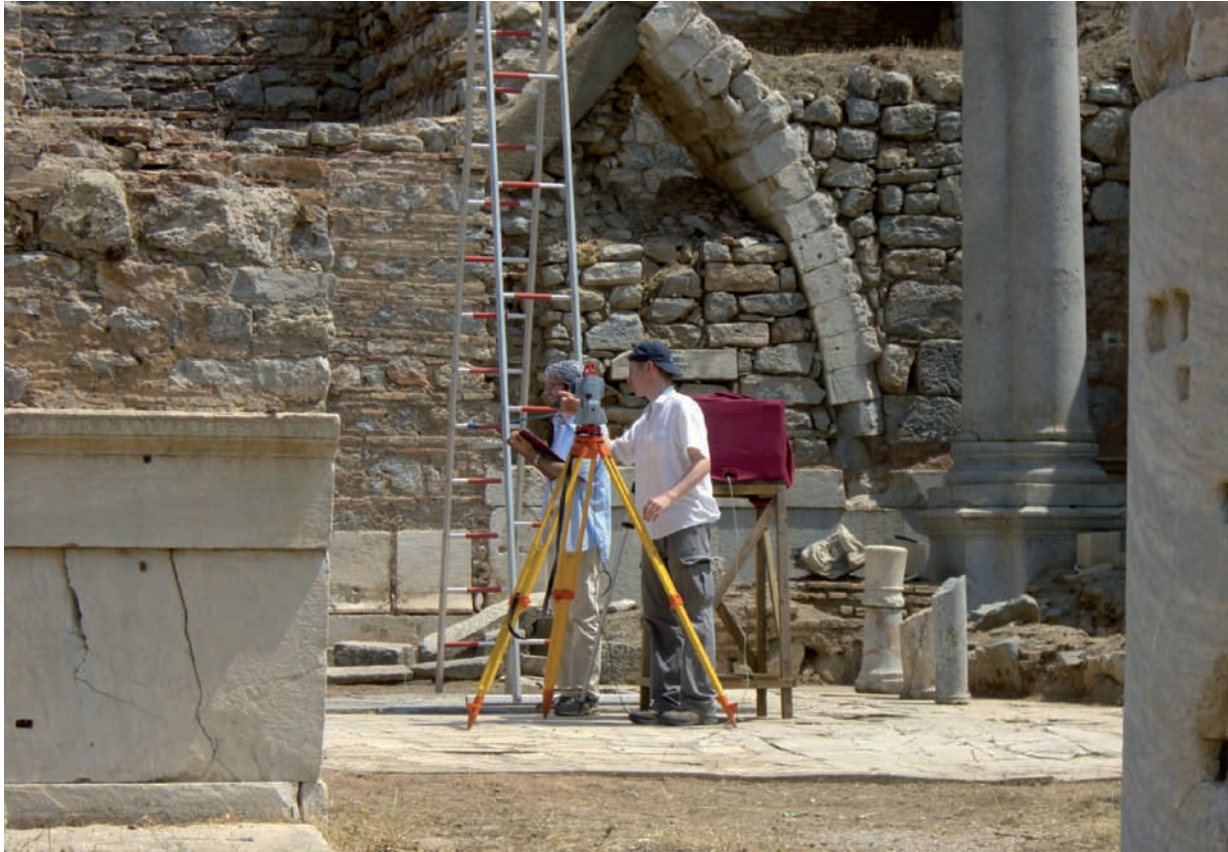
1 »Hestiasaalk. Fotogrammetrische Aufnahme der Westwand
