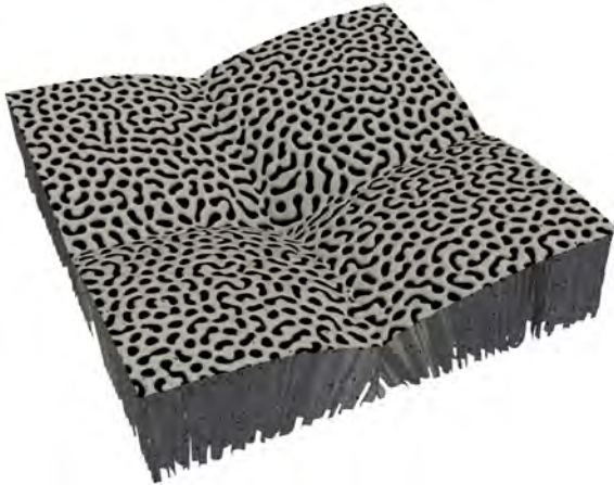
Abbildung 10.25: Erstarrungsfront einer dreidimensionalen Phasenfeldsimulation eutektischer Kolonien des Systems NiAl-34Cr.
