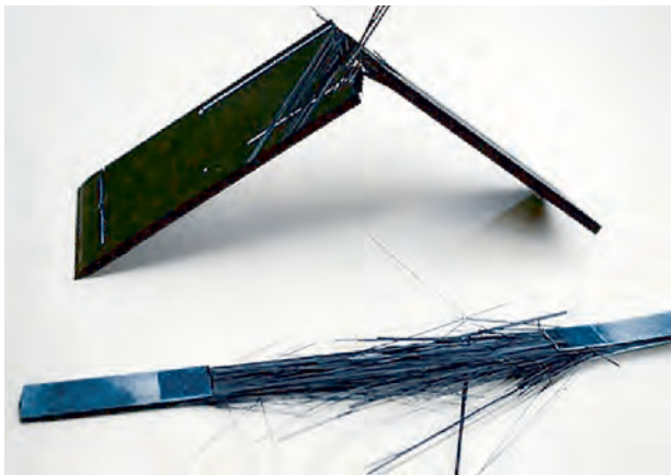
Abb. 6 Versagen von CFK unter Biegung und Zug (Quelle: [CTQ GmbH 2017]) ( http://doi.org/10.33968/9783966270021-02-A-04 )
