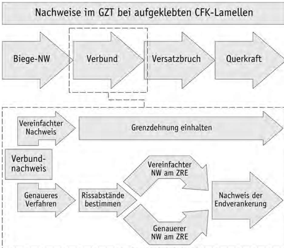
Abb. 15 Ablaufschema des Nachweisverfahrens bei aufgeklebten CFK-Lamellen (Quelle: Eigene Darstellung in Anlehnung an [DAfStb-Heft 595] Bild H.8, S. 17) ( http://doi.org/10.33968/9783966270021-02-A-13 )
