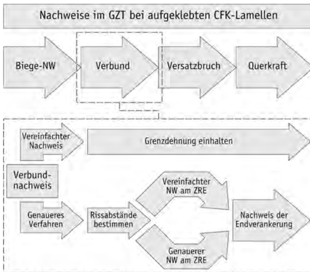
Abb. 55 Ablaufschema des Nachweisverfahrens bei aufgeklebten CFK-Lamellen (Quelle: Eigene Darstellung in Anlehnung an [DAfStb-Heft 595] Bild H.8, S. 17) ( http://doi.org/10.33968/9783966270021-05-A-01 )
