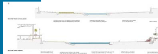
Figura 11 Le sezioni trasversali del fiume all'interno del tratto rinaturalizzato e nell'ambito urbano attraversato dal Besòs.
