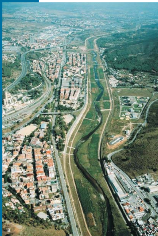
Figura 4 Foto aerea del tratto rinaturalizzato del fiume attraverso la ricreazione dell'andamento a meandri e l'inserimento di zone umide per il trattamento delle acque.
