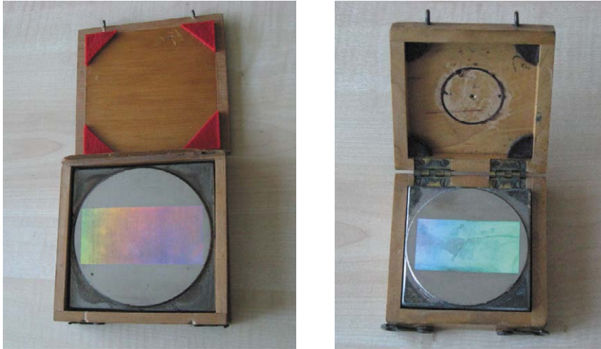
Figura 48 – I due reticoli Rowland, utilizzati dalla Brunetti, conservati presso il Dipartimento di Fisica e Astronomia, Università di Firenze. Entrambi sono stati prodotti da una collaborazione tra l’Officina John Brashear di Pittsburg e il Laboratorio di Fisica dell’Università di Baltimora. [Foto di G. Molesini]
