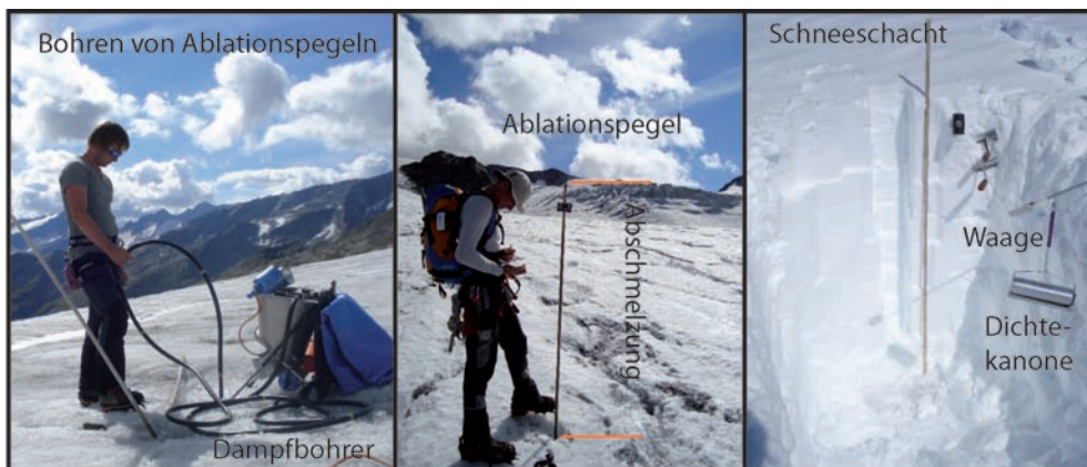
Abb. 11: Bestimmen des Massenhaushalts nach der direkten glaziologischen Methode. (Foto: A. Fischer)
