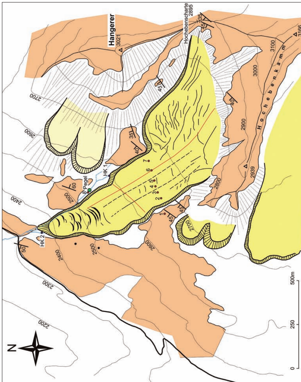
Abb. 13: Geologisch-morphologische Karte des aktiven Blockgletschers im Äußeren Hochebenkar. HK 1 und HK 2: Sedimentproben, Punkte 1 – 8 markieren die Stellen, an denen die Temperaturen an der Basis der winterlichen Schneedecke (BTS) gemessen wurden. Rote Linien: Georadar-Profile. (Foto: K. Krainer)
