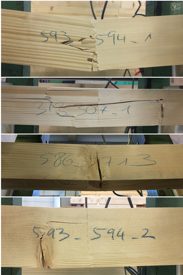
Bild A.20: Versagensarten bei KZV-Biegeversuchen; v. o. n. u.: Versagen an KZV, Versagen an KZV und umgebendem Holz; Versagen an KZV und Ast (hier: Ast in KZV); Versagen an Ast ohne Beteiligung der KZV
