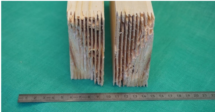
Bild 4.30: Querschnitt einer KZV mit einem Ast in einem der Halbraupe einer EL
