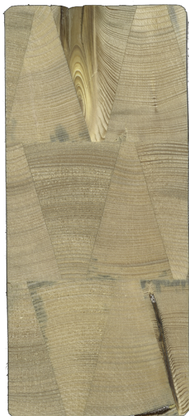
Bild 1.5: Darstellung eines Segmentschichtholzquerschnitts (B x H) 120 x 270 mm 2 bestehend aus drei SLH-Lamellen
