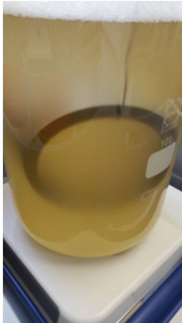
Abbildung A.9: Abbildung der chemischen Vorbehandlung zur Verbesserung der Adhäsion von Resist und Nickelstrukturen. Beispielhaft: Stahlhülse in der Abkochentfettung
