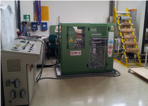
Abbildung 4.1: Laborkalender am IMT als Kernelement der R2R-Prägeanlage
