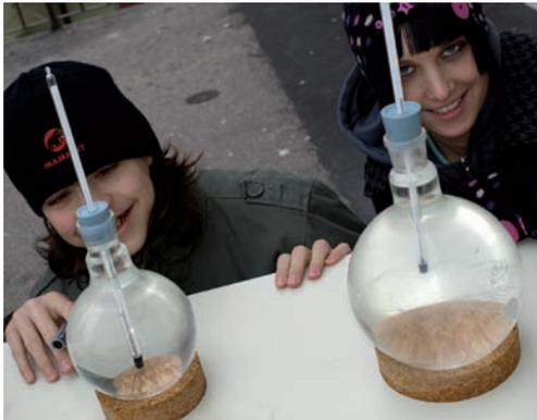
*Versuch zum Nachweis der Bergmann'schen Regel: Größenabhängigkeit des Wärmeverlustes.
