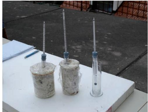
*Isolationsversuch mit verschieden dicht gepackten Federn.
