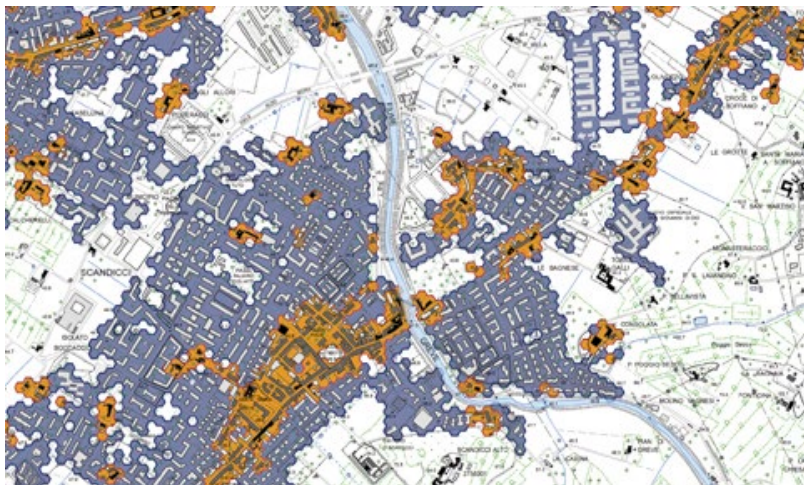
Figura 9. Scandicci (FI), in blu le aree ad edificato continuo al 2012, in arancione al 1954; sovrapposizione fra i perimetri individuati dal modello geo-statistico e la Carta Tecnica Regionale in scala 1:10.000.
