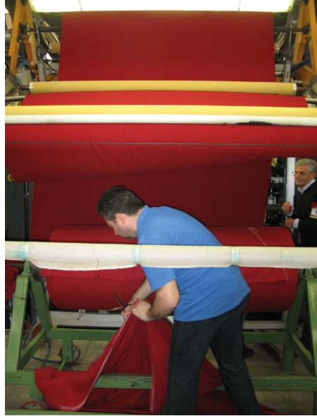
Figura 48b – Garzatura e cimatura a secco (macchina marca Lafer).
