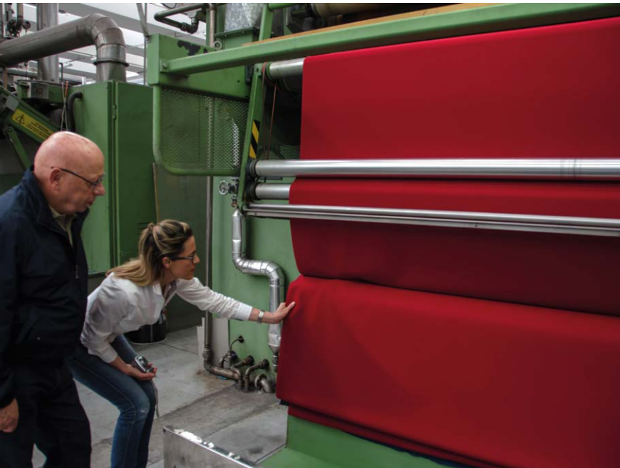
Figura 49 – Vaporizzazione e decattizzazione in continuo (macchina marca Sperotto).
