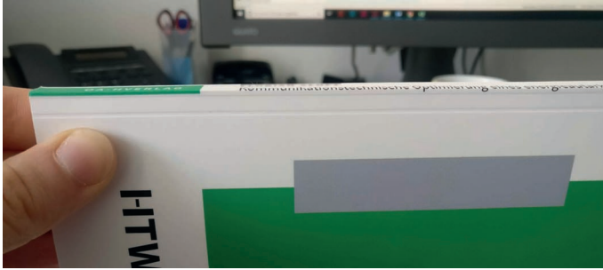
Abb. 25 Reklamation: Elemente des Buchrückens ragen auf die U1 des Buches (Fall 2)
