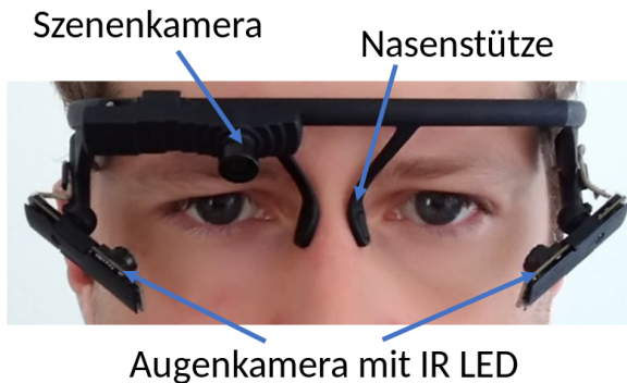
Abbildung 2.3: Mobiles Blickmessgerät pupil von pupil labs [Kas14]
