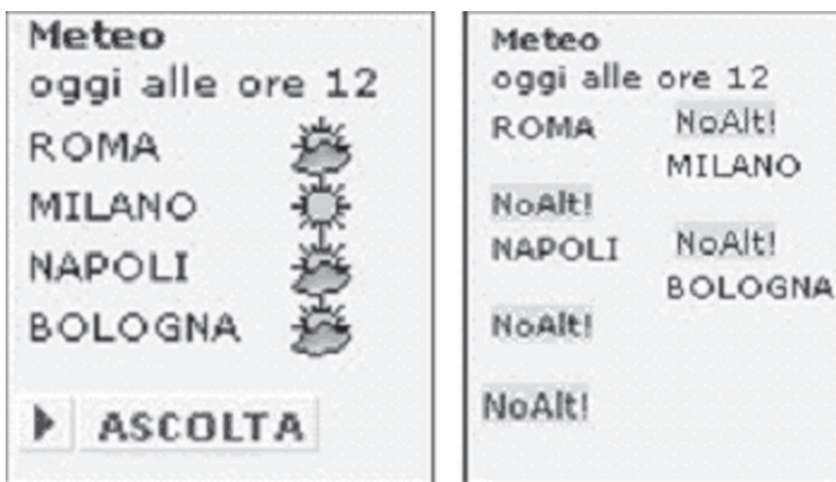
Figura 6.1 Pagina delle previsioni del tempo vista con Explorer (a sinistra); pagina delle previsioni del tempo vista disabilitando le immagini (a destra).
