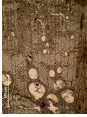
Figura 25. Plano transversal. Vasos aislados en anillo poroso.
