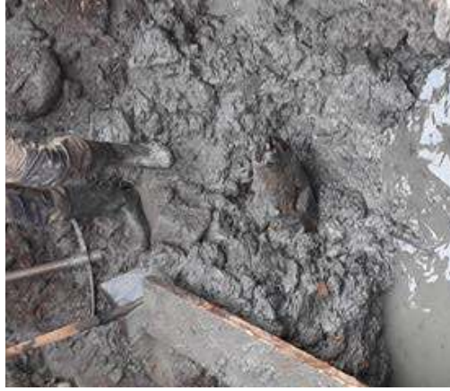
Figura 15. Tablón sur en el que se observa la acción de los invertibrados xilófagos.
