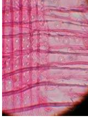
Figura 33. Corte radial correspondiente al Tablón Norte. Señaladas las punteaduras areoladas.
