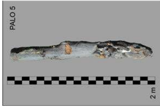
Figura 13. Palo 5. Obsérvase el proceso de deterioro del mismo en su parte inferior; la superior, aunque aparentemente bien conservada, prácticamente se deshacía al contacto.
