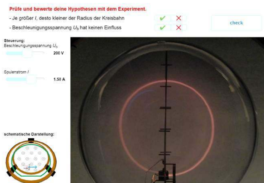
Abb. 66: Experimentieroberfläche zur Elektronenbewegung im homogenen Magnetfeld
