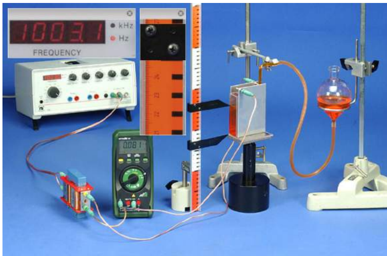
Abb. 9: Interaktives Bildschirmexperiment zur kapazitiven Füllstandsmessung. Verfügbar unter http://didaktik.physik.fu-berlin.de/~juek/ibe_html/kapf_Kapazitive_Fuellstandsmessung/index.html (abgerufen am 17.01.2018)
