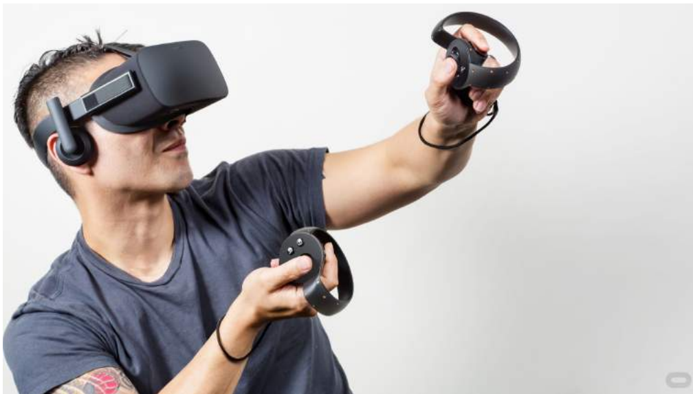
Abb. 16: Head Mounted Display Oculus Rift mit Oculus Touch als Interaktionssteuerung Bildquelle: https://www.oculus.com/blog/the-oculus-rift-oculus-touch-and-vr-games-at-e3/ (abgerufen am 14.01.2018)
