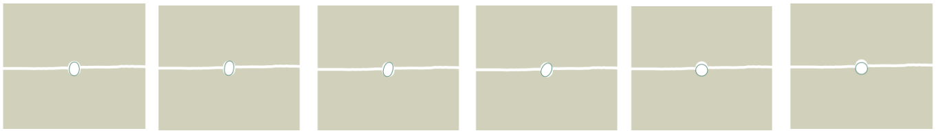
(a) (b) (c) (d) (e) (f) Figure 10: Crack pattern microcapsule of \sigma^* 10% (0.6 Mpa) with different G_f values. (a) G_f 100% (b) G_f 75% (c) G_f 50% (d) G_f 25% (e) G_f 10% (f) G_f 5%
