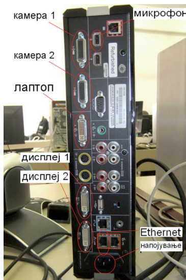
Слика 4. Задната страна на Polycom HDX 8000 – влезови за камера 1, камера 2, лаптоп за содржина, дисплеј 1, дисплеј 2, микрофон, Ethernet и влез за кабелот за напојување
