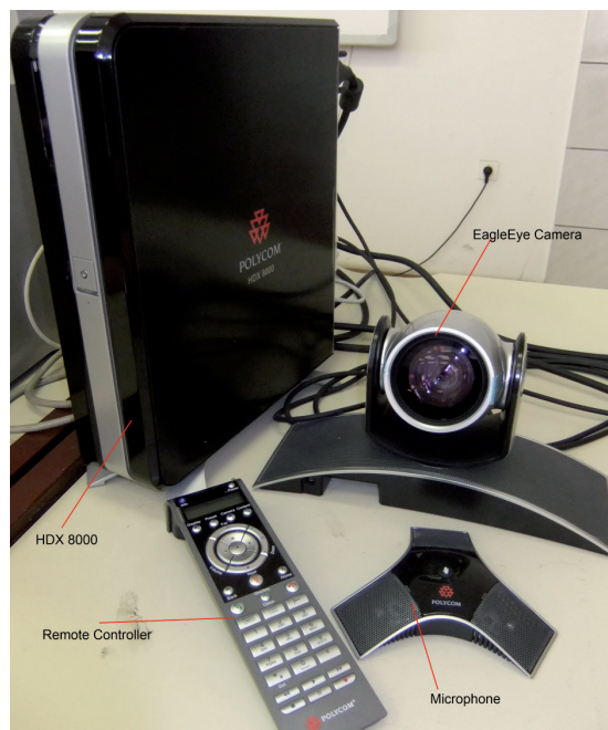
Slika 1. Polycom i konferencijska oprema – HDX 8000 terminal, EagleEye kamera, daljinski upravljač i mikrofoni
