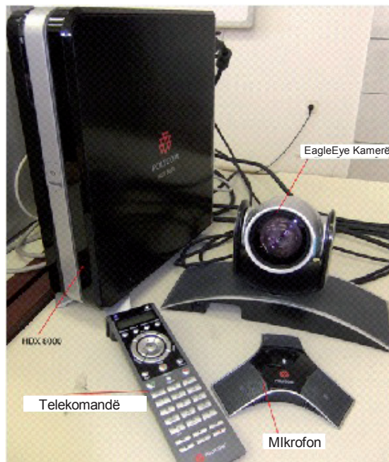
Figura 1. Pajisja për klientin për konferenca të Polycom – pikë e fundit HDX 8000, EagleEye kamerë, telekomandë dhe mikrofon
