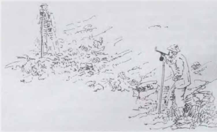
Abb. 94: Wegvermessung. Der Vermesser, rechts im Bild, visiert die Marke auf dem von einem Gehilfen gehaltenen Stab an und konnte so die Neigung des Geländes feststellen.
