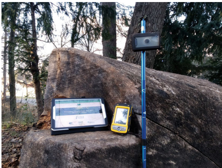
Fig. 4.1 GNSS navigation, positioning and data recording devices used during the field campaign of INFC2015 / La strumentazione per la navigazione, il posizionamento e la registrazione dei dati utilizzata durante i rilievi in campo INFC2015
