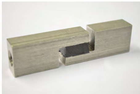
Abbildung 4.22: Foto der verwendeten Zugscherprobe (Quelle: eigene Aufnahme)
