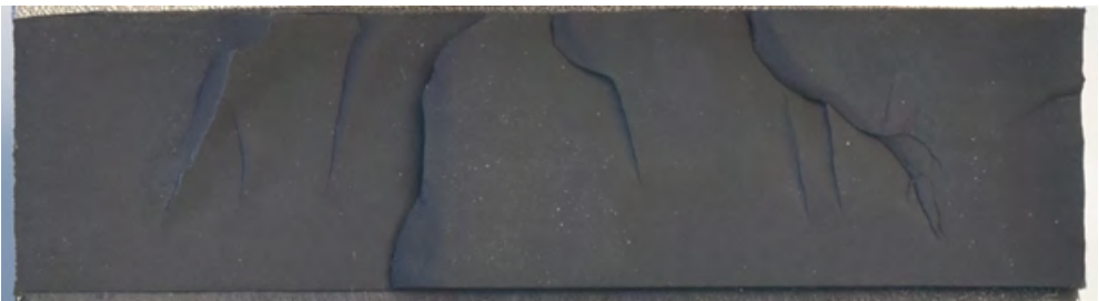
Abbildung 4.49: Exemplarische Bruchfläche bei T = RT und Nenngleitrate: 0,416 \text{ mm}^{-1} (Geometrie 24 \text{ mm} \times 6 \text{ mm} \times 100 \text{ mm} , Werkstoff SGB) (Quelle: eigene Aufnahme)
