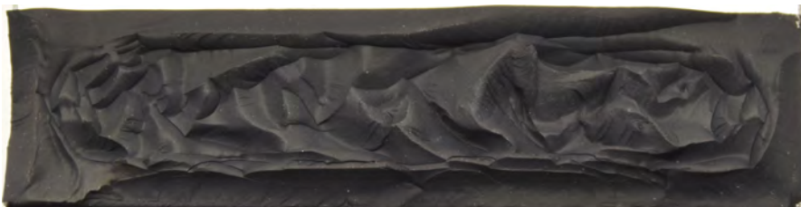
Abbildung 4.55: Exemplarische Bruchfläche bei T = +80 \text{ }^\circ\text{C} und Nenndehnrate: 0,416 \text{ mm}^{-1} (Geometrie 24 \text{ mm} \times 6 \text{ mm} \times 100 \text{ mm} , Zug, Werkstoff SGA) (Quelle: eigene Aufnahme)
