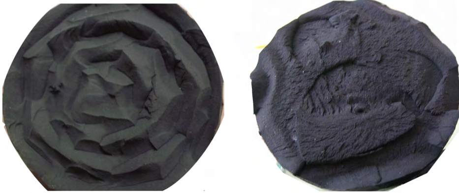
Abbildung 2.7: Veränderung des Bruchbildes eines Kopfzugprobe infolge der Erhöhung der Testgeschwindigkeit (links: v_t = 5 \text{ mm/min} , rechts: v_t = 3 \text{ m/s} , Klebstoff DC993) (Quelle: eigene Aufnahmen)
