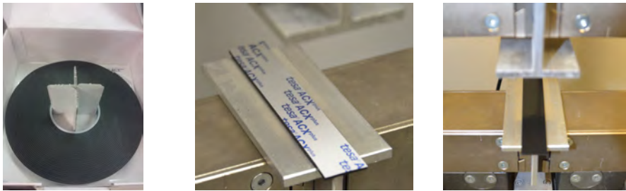
Abbildung 4.29: Anlieferungszustand (links) und Applikationsversuche mit Aluminiumprofilen (Mitte und rechts) (Quelle: eigene Aufnahmen)
