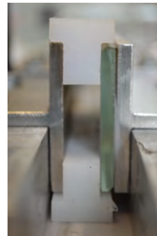
Abbildung 4.28: Fertigung der Probekörper mit Negativformen (Quelle: eigene Aufnahmen)
