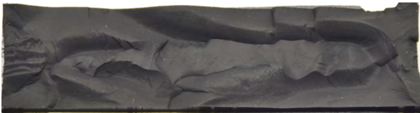
Abbildung 4.54: Exemplarische Bruchfläche bei T = -20 \text{ }^\circ\text{C} und Nenndehnrate: 41,6 \text{ mm}^{-1} (Geometrie 24 \text{ mm} \times 6 \text{ mm} \times 100 \text{ mm} , Zug, Werkstoff SGA) (Quelle: eigene Aufnahme)
