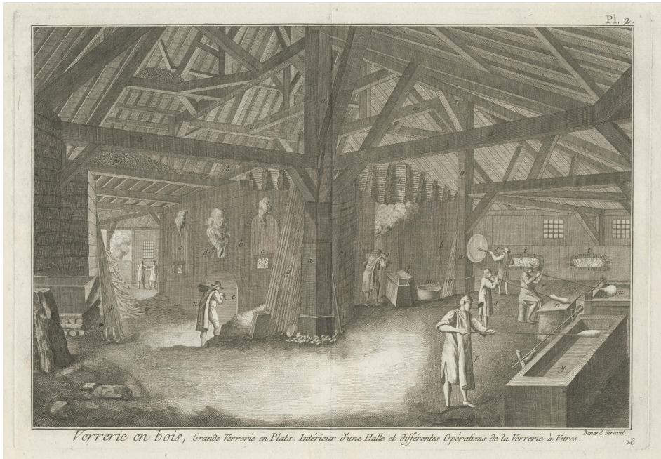
5 Diderot, making plate glass by the crown method, Recueil de planches, sur les sciences, les arts libéraux, et les arts mécaniques, avec leur explication. Manufacture des glaces , 1772, vol. 10, pl. 2. Collection of the Rakow Research Library, The Corning Museum of Glass.
