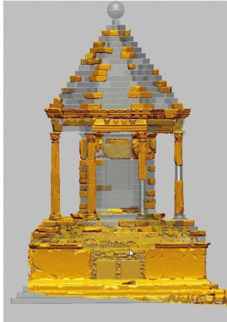
Abb. 17 b Oktogon, virtuelle Anastylose (Bauteile und Ergänzungen)
