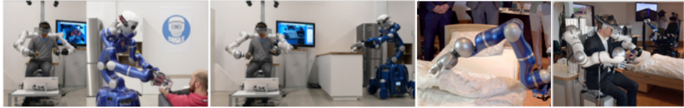
Abbildung 16.11: Injektion (l.), Bettenaufbereitung (r.) in Teleoperation bzw. mit geteilter Kontrolle durchgeführt.
