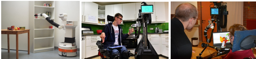
Abbildung 16.3: Robotersysteme TIAGo und Marvin: Links: TIAGo sortiert Objekte auf Basis eines nutzerspezifischen Weltmodells (RA2), Mitte: Roboter Marvin schenkt Glas Wasser ein; Rechts: Proband teleoperiert Roboter Marvin mittels Mundsteuerung.
