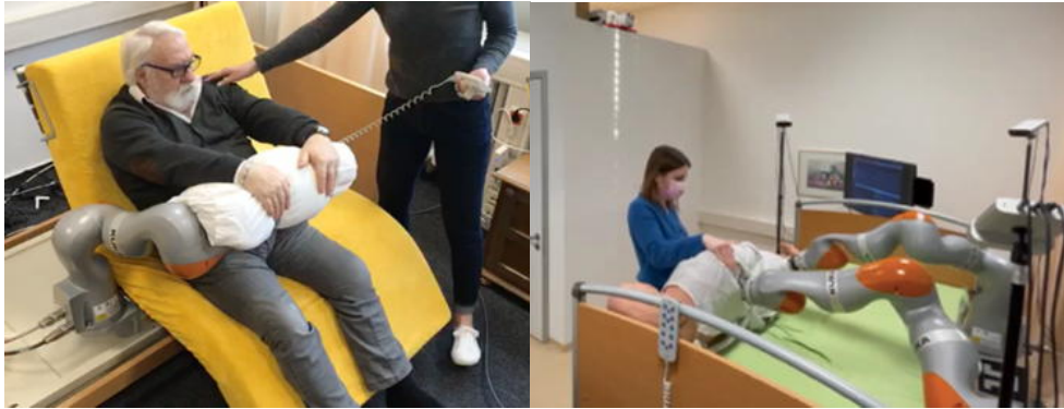
Abbildung 9.6: Manipulatoren (KUKA iiwa) montiert an einem aktuierten Pflegebett.
