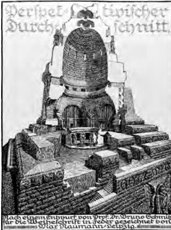
Abb. 8 Leipzig, Völkerschlachtdenkmal, perspektivischer Schnitt (nach einer Zeichnung von Max Naumann).
