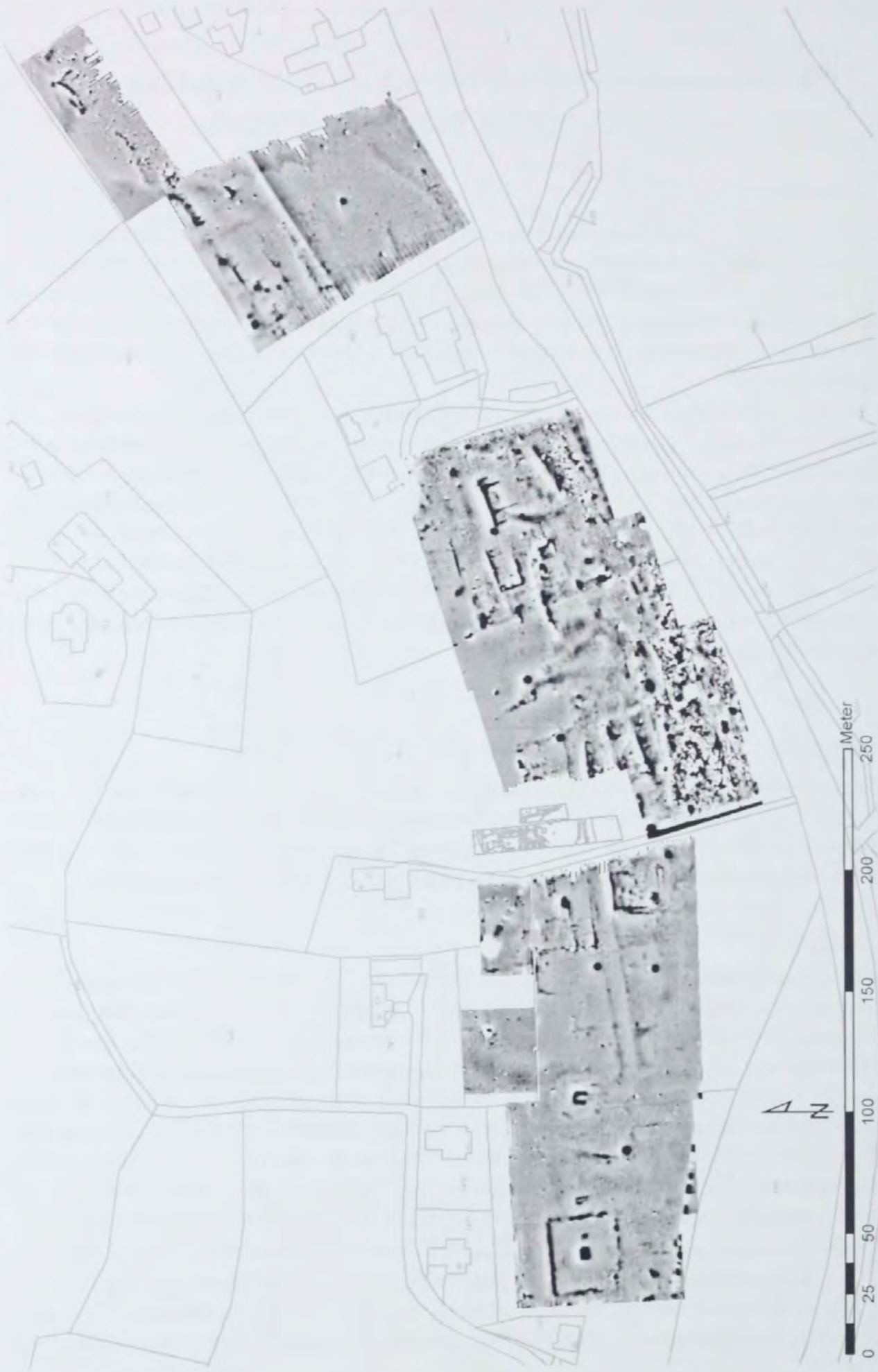
Abb. 64: Magnetogramm der geophysikalischen Prospektion in Saaz 2004. Korrigierte und kontrastverstärkte Rohdaten, dargestellte Fläche 39,774 m 2 . Messdynamik -8,0, 12,0 nT in 254 Graustufen.
