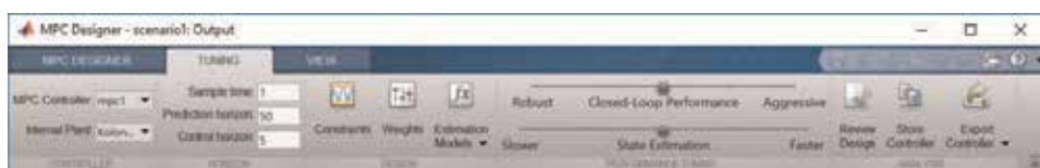
Bild 12. Eingabemöglichkeiten unter dem Tab “TUNING”.
