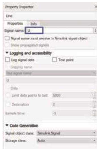
Bild 163. Eintragung eines Namens an einer Signallinie im Property Inspector.
