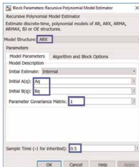
Bild 160. Eingabemaske für den Baustein “Recursive Polynomial Model Estimator” (Reiter “Model Parameters”).
