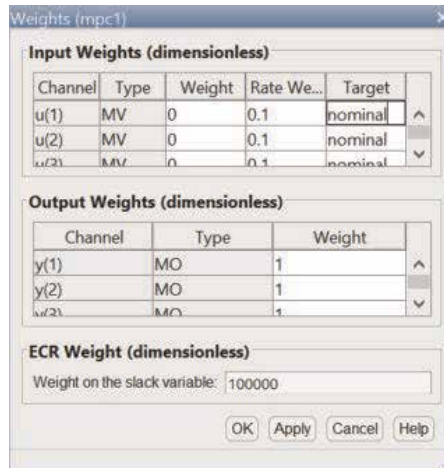
Bild 21. Fenster zur Vorgabe der Gewichtungsfaktoren und der MV Targets.
