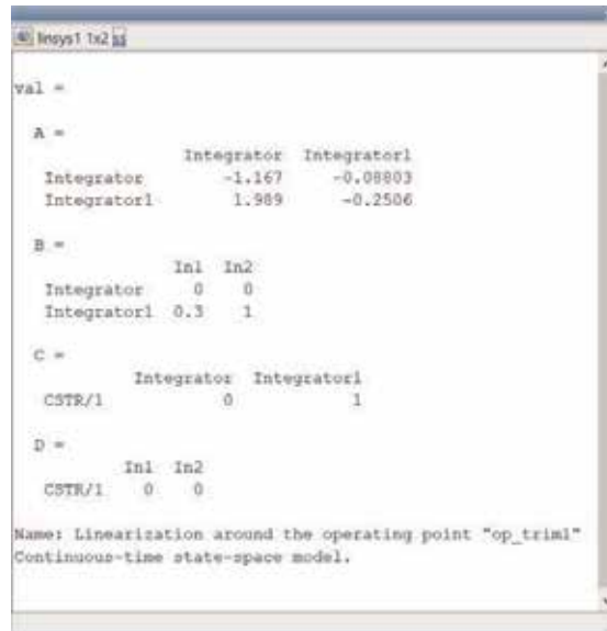
Bild 146. Parameter des linearen Zustandsmodells "linsys1".
