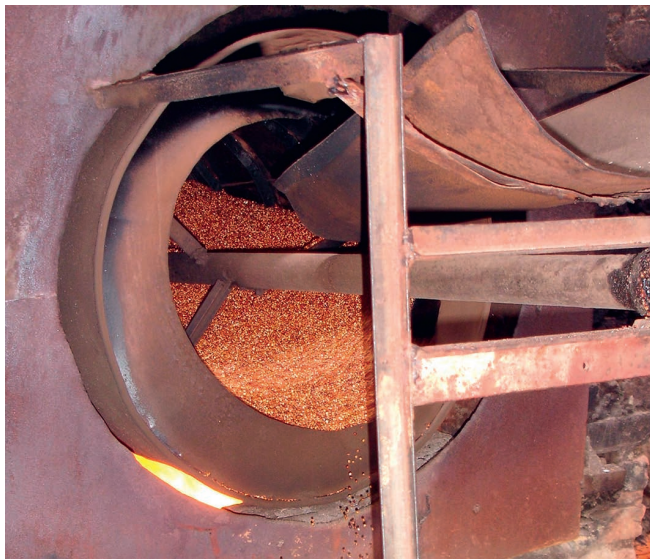
Photo 31. Torréfaction du soja pour la fabrication de farines infantiles au Burundi (© Jean-François Cruz, Cirad).
