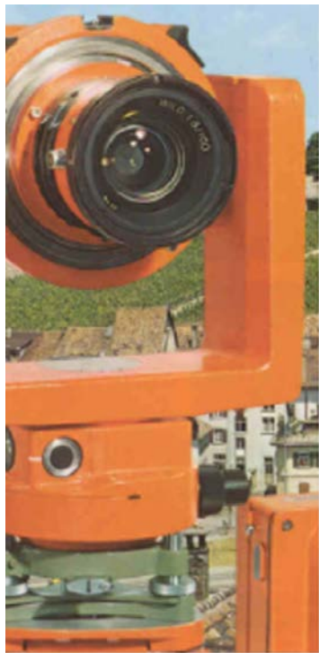
Fig. 8. Sulla sinistra, la camera metrica Wild P31 (< http://www.wild-heerbrugg.com/photogrammetry1.htm >). Sulla destra, certificato di calibrazione della camera con lo schema esemplificativo della posizione dei punti fiduciali e dei punti principali di simmetria e auto collimazione rispetto alla croce centrale impressa sulla pellicola.
