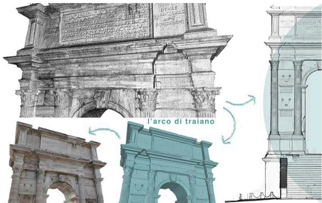
Fig. 9. Approfondimento tridimensionale sull'Arco di Traiano, uno dei POI del Local Virtual Museum del porto di Ancona. Nuvola di punti, modello mesh, modello texturizzato e ortotimmagine in scala di grigi.
