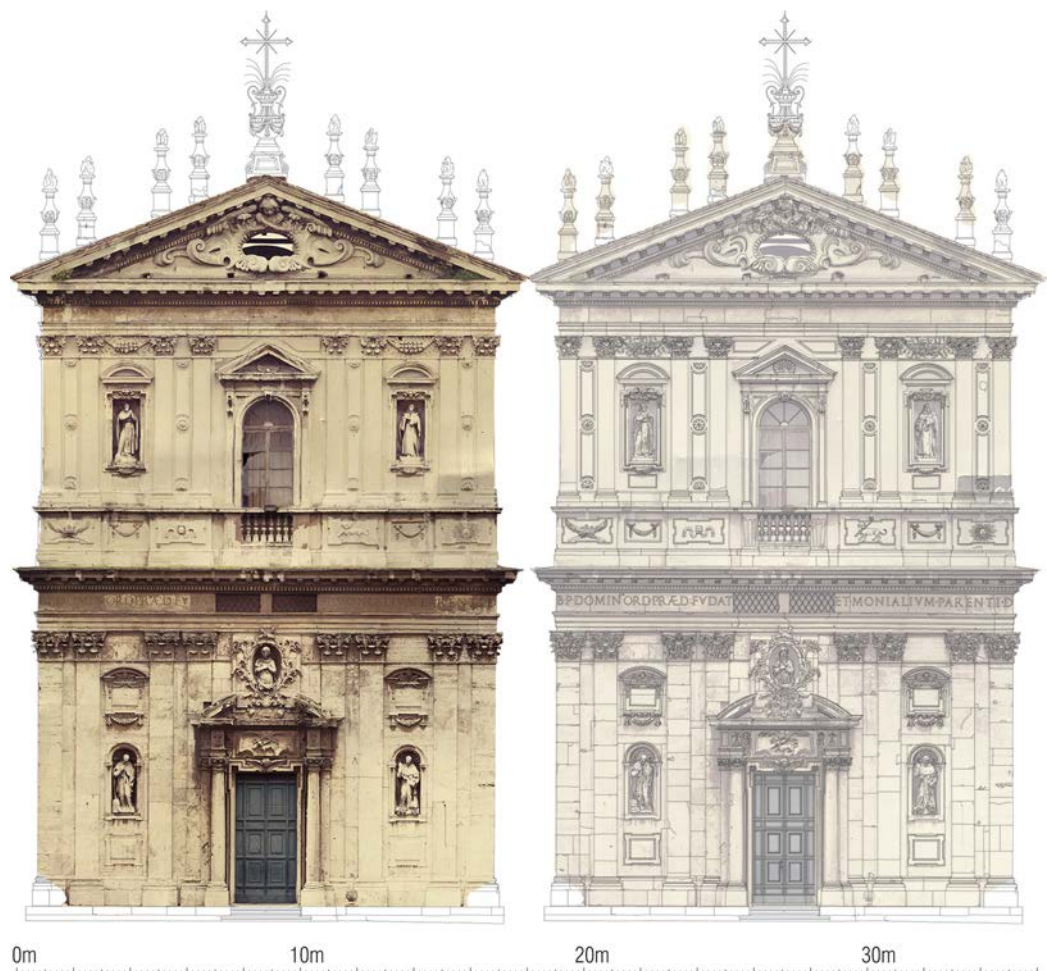
Fig. 11 Sulla sinistra, l'ortoimmagine realizzata tramite processi fotogrammetrici digitali. A destra, sovrapposizione della restituzione del 1998 con l'ortoimmagine per la verifica metrica e morfologica dei due elaborati.
