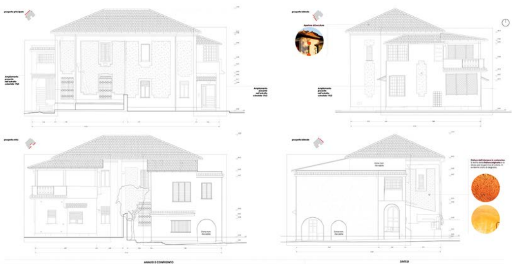
Fig. 11. Rilievo dello stato di degrado di uno dei villini della borgata giardino del Pigneto (elaborazione grafica Valentina Apostoli).
