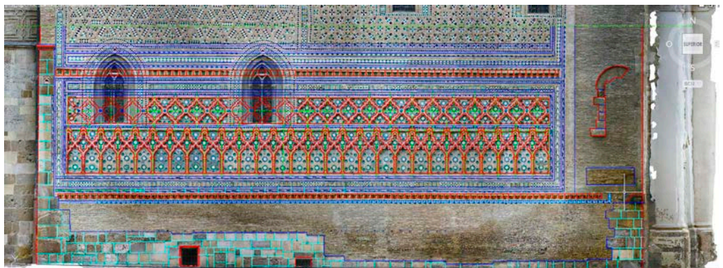
Fig. 8. Simulación repitiendo la trama de ladrillo sobre las ventanas góticas. Fuente autor:
