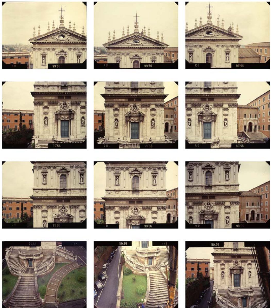
Fig. 5. Rilievo della chiesa dei SS. Domenico e Sisto, 1998. Positivi su pellicola 5x4 pollici scattati con camera metrica Wild P31, acquisiti con scanner Epson Perfection V700 a 6400 dpi.
