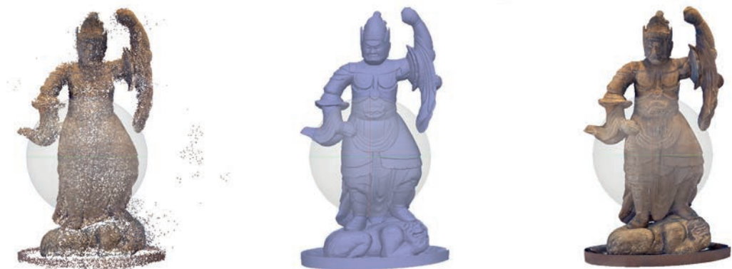
Fig. 5. Generazione della nuvola densa, del modello mesh, del modello texturizzato (elaborazione digitale di S. Tamantini).
