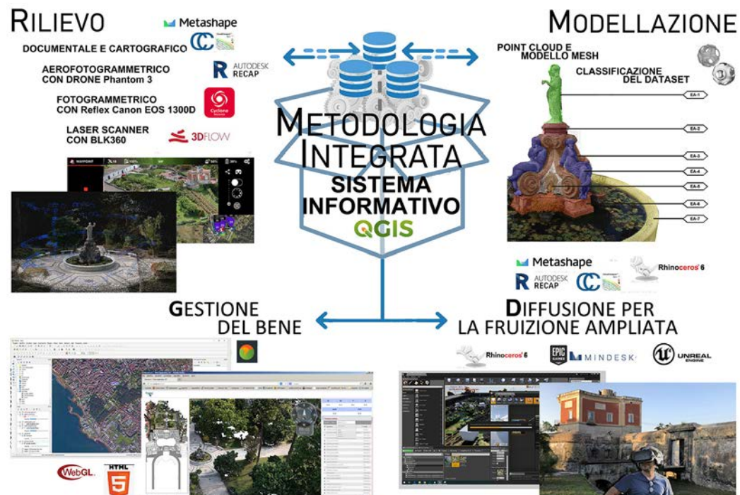
Fig. 2. Schematizzazione del Sistema digitale integrato di gestione e fruizione del complesso architettonico e paesaggistico.
