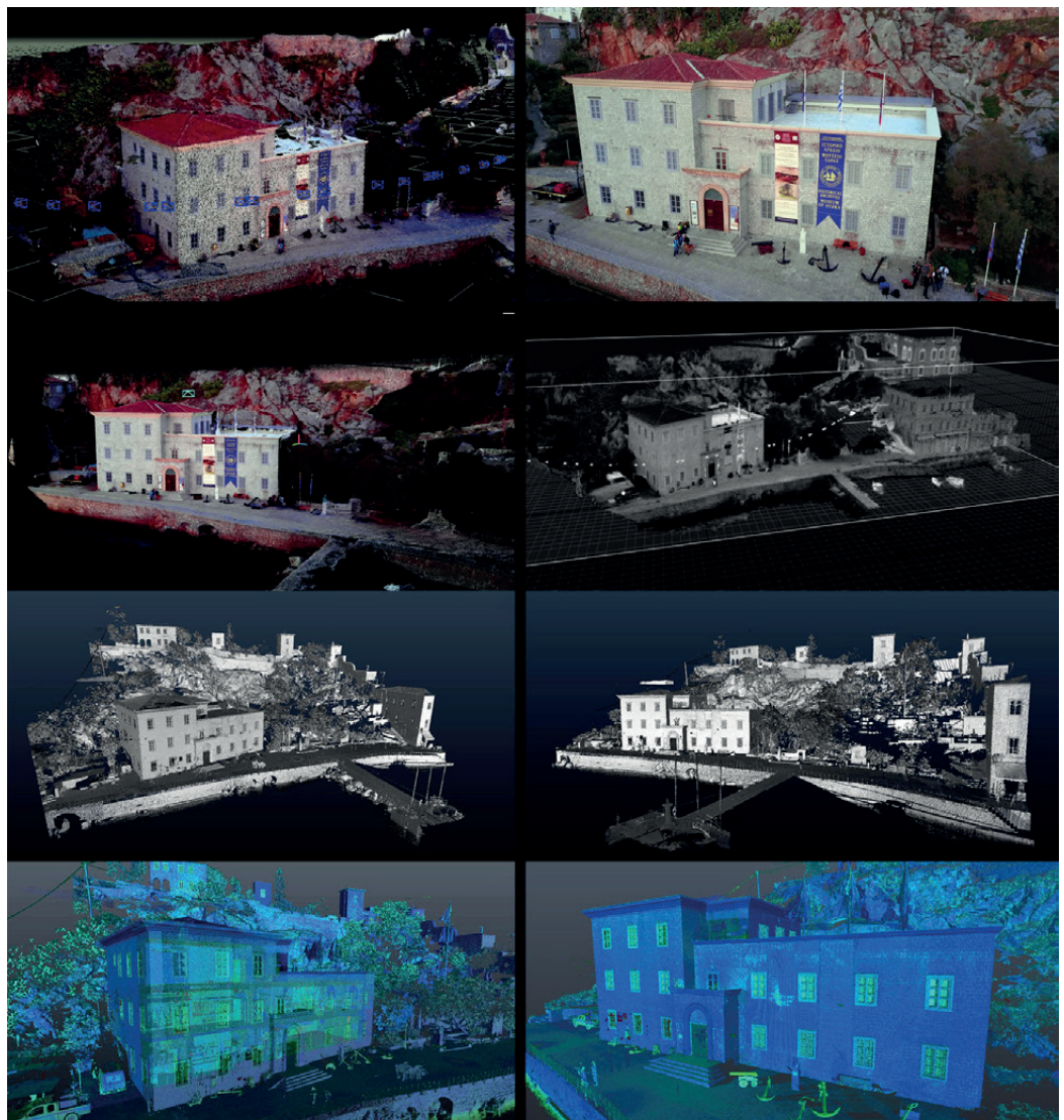
Fig. 5. Il rilievo dell'intero complesso del Museo è stato effettuato utilizzando con una metodologia ibrida, integrando i dati da laser scanner terrestre con quelli della fotogrammetria aerea per raggiungere le aree non raggiungibili da terra, come le coperture o sovra squadri.
