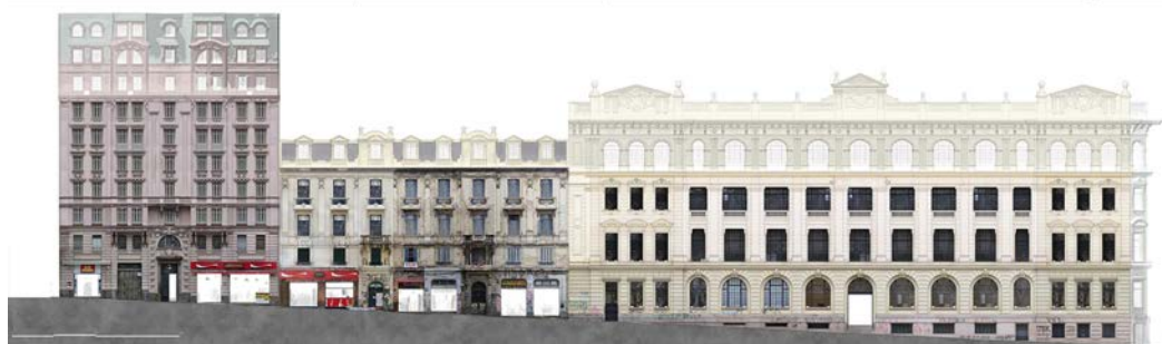
Fig. 11. In alto: esempio di schedatura delle facciate degli edifici dell'Avenida São João. In basso: disegno in CAD e fotopiano di una porzione dell'Avenida (elaborazione grafica A. Cottini, C. Alessi).
