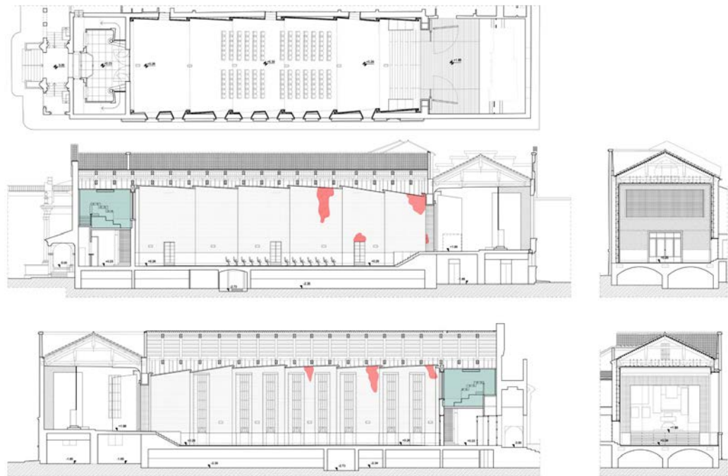
Fig. 4. Lo stato di fatto della sala concerti prima degli interventi di bonifica. Restituzione da rilievo digitale integrato, rilievo topografico e rilievo diretto.
