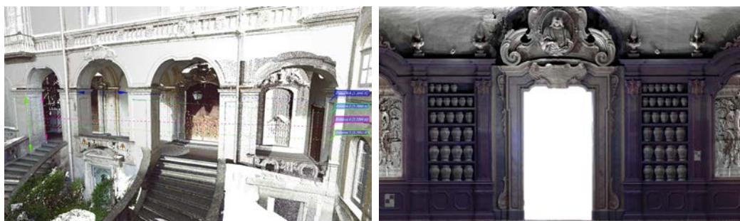
Fig. 5. Pulizia e filtraggio della nuvola, mappatura con i dati immagine.
