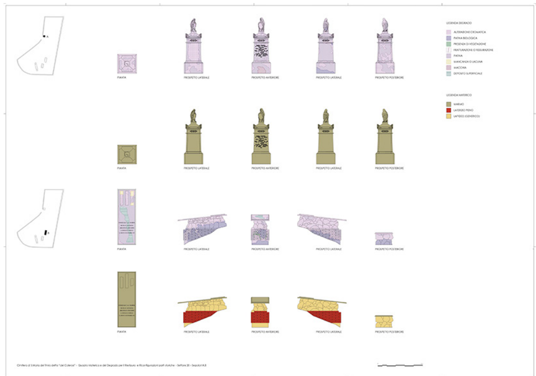
Fig. 9. Il Cimitero dei Colerici a Napoli. Quadro materico e del degrado. Settore 20. Sepolcro A-B.
