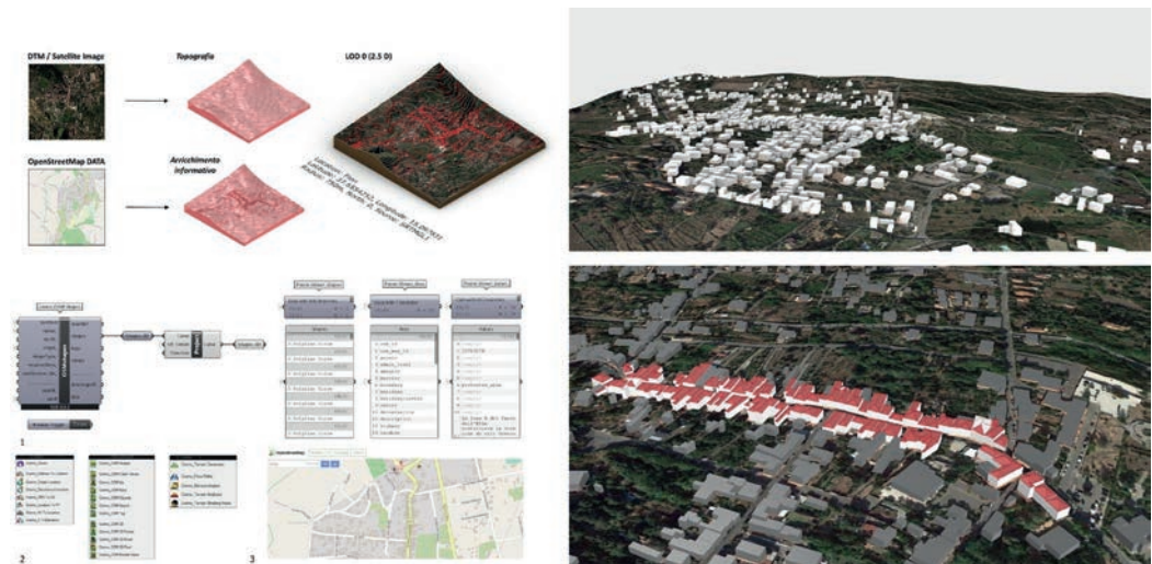
Fig. 9. Modello LOD 0 (in alto a sinistra) e LOD 1 (in alto a destra), codice VPL per l'estrazione di metadati da OpenStreetMap (in basso a sinistra) e modello LOD 2 (in basso a destra).
