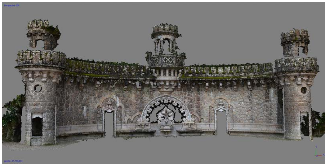
Fig. 3. La Quinta da Regaleira a Sintra, o Portal dos Guardias, nuvola dei punti ottenuta attraverso il rilievo fotogrammetrico su software digitale.
