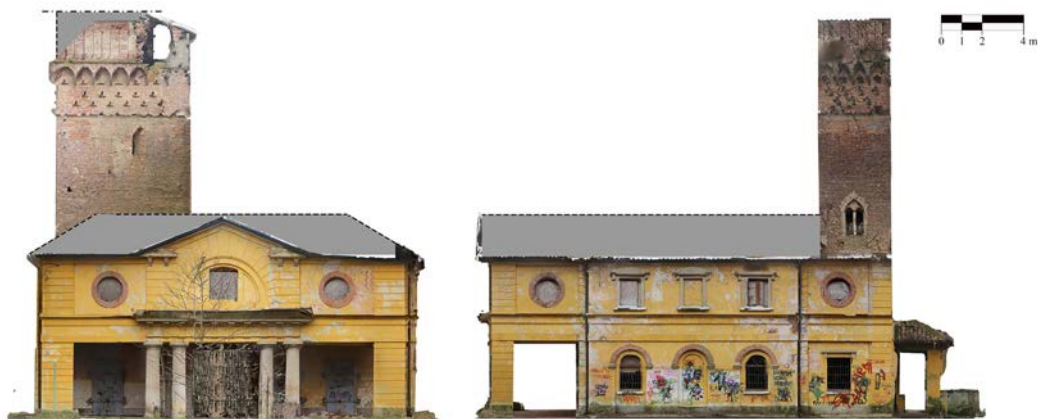
Fig. 7. Orto-immagini del test C: prospetti sud (sinistra) e ovest (destra).
