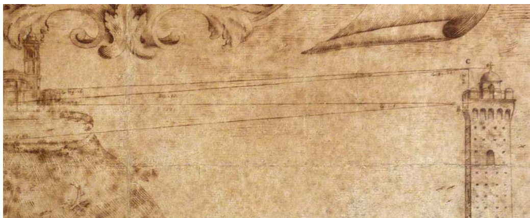
Paolo Battista Balbi, 1714, Typus ostendens praxim adhibitam in excessu quaerendo Turris Asinellae supra pavimento dor- mitorij monachorum divi Michaelis in Busco [BCA- Bo, Gabinetto Disegni e Stampe, Cart. I, 3].
