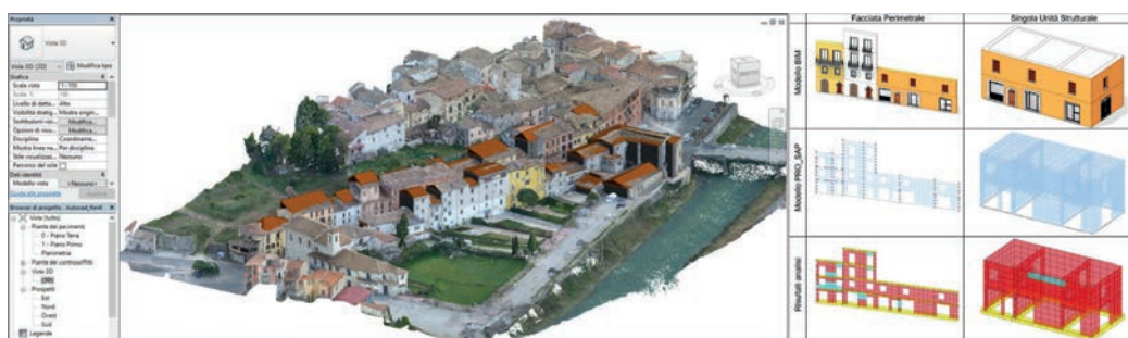
Fig. 4. Da sinistra a destra: allineamento rilievo fotogrammetrico digitale al modello BIM e analisi strutturale in PROSAP [Pelliccio 2017].
