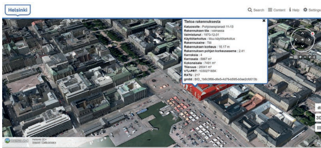
Fig. 2. Vista del sistema informativo tridimensionale Helsinki 3D+. È possibile consultare il sistema sia come CIM (realizzato a partire da geo-dati, modelli BIM e nuvole di punti da laser scanner) che come 'Reality Mesh Model' (modello poligonale fotogrammetrico ottenuto da riprese aeree dell'intera città. Fonte: Helsinki 3D+ Information Model. < https://kartta.helsinki.fi/3d/ > (consultato il 10 marzo 2021).
