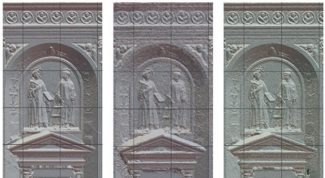
Fig. 6. Confronto tra modelli fotogrammetrici: il primo da sinistra è stato realizzato creando una mesh a partire dal solo dato laser scanner; il secondo dal dato fotografico (ottenuto da una Sony alfa7); il terzo integrando entrambi i dati scanner e fotografici. È evidente come il primo modello garantisca una morfologia più adeguata a descrivere le forme dell'architettura.
