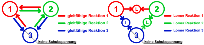
Abbildung 5.22.: Schematische Übersicht der Konfiguration der drei Gleitsysteme \xi = 1, 2, 3 gleitfähigen und Lomer Reaktionen im Zusammenspiel.
