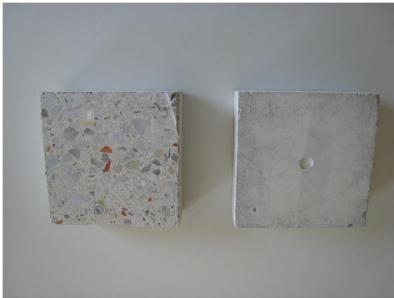
Abb. 3: Vergleich gesägter Probekörper von RC-Beton und geschalte Fläche (Bild: Schwenk)
