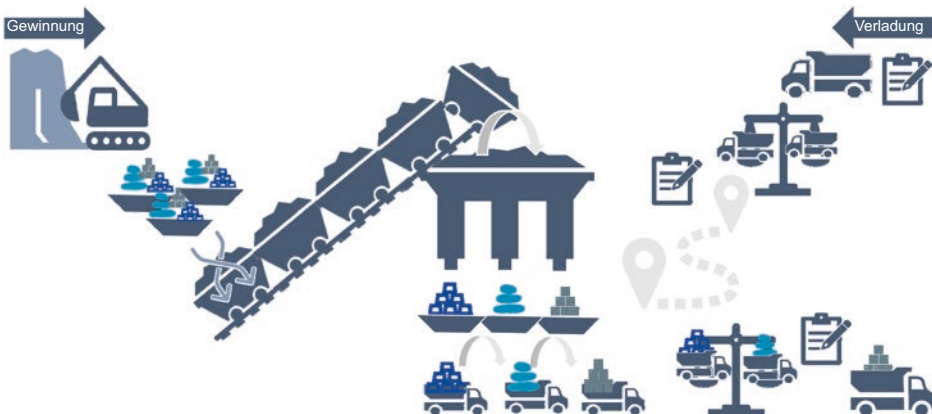
Abb. 5.17 Visualisierung des Aufbaus und Ablaufs des AnGeWaNt-Planspiels in Anlehnung an einen realen Kieswerkprozess ([7, 54] modifiziert)
