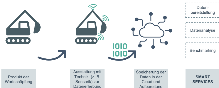
Abb. 5.1 Vereinfachte, exemplarische Darstellung von Hybridisierung am Beispiel eines Nutzfahrzeugs ([3] modifiziert)
