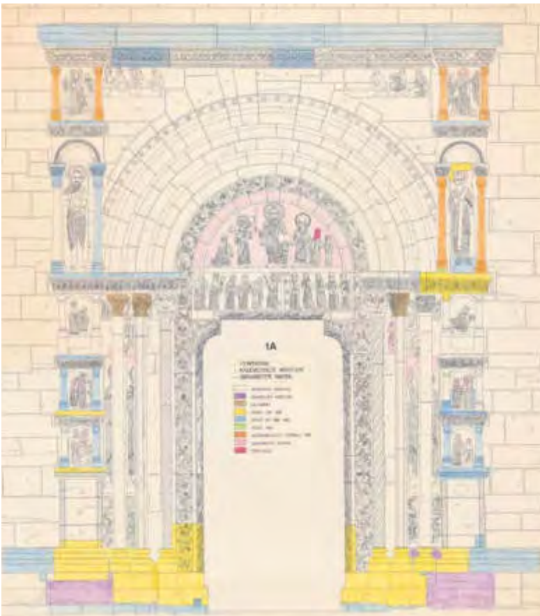
ABB. 173 Nordquerhausfassade, Galluspforte, Kartierung der Steinsorten, der ersetzten Werkstücke und der überarbeiteten Partien. Weiss: Wiesentaler Sandstein, violett: Degerfelder Sandstein, ocker: Kalkarenit, gelb: bereits vor 1880 ausgewechselte Steine, blau: Quader der Renovation 1880–1890, grün: 1988 ersetzte Quader, rubinrot: 1988 wieder eingesetzte Originale, rosa: überarbeitete Partien, dunkelrot: Mörtelguss. Kartierung Marcial Lopez MBH, 1988/89. DpfbS.
