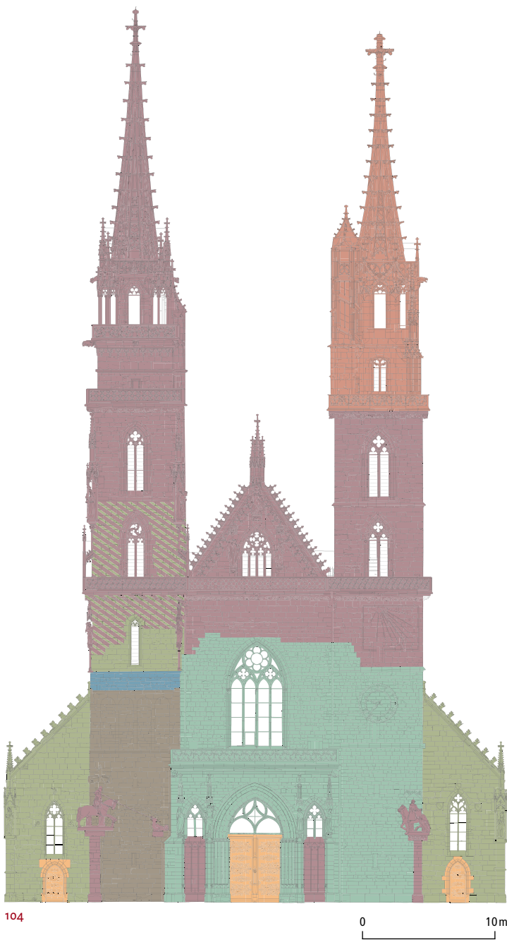
ABB. 104 Westfassade, Bauphasenplan. 1:400. Es lassen sich grob vier Phasen unterscheiden: der romanische Sockel des Georgsturms, der hochgotische Neubau der Fassade mit der Erweiterung zur Fünfschiffigkeit, die Reparatur um 1400 und die Vollendung der Türme im Laufe des 15. Jh. Fotogrammetrischer Plan GBVD, bearbeitet von Daniela Hoesli nach Vorgaben von Hans-Rudolf Meier, 2018. KHist UZH.
