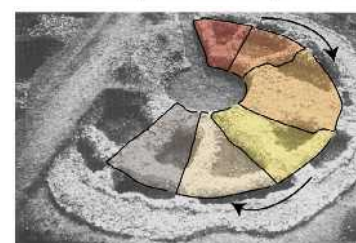
construction par portions
