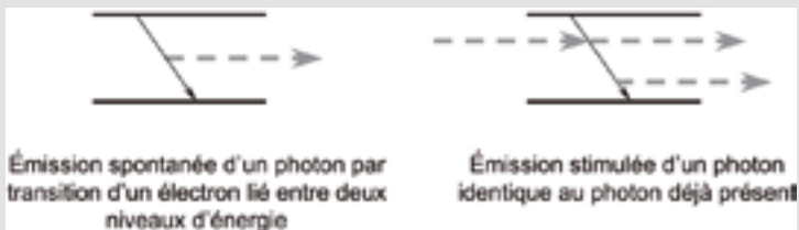
Figure 2 | Émission spontanée, émission stimulée. L'émission stimulée apporte une possibilité d'amplification de l'intensité lumineuse.
