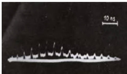
Figure 30 | Train d'impulsions issues d'un oscillateur laser bloqué en phase, enregistré par un oscillographe cathodique. La largeur des pics, représentative de la dynamique de l'instrumentation utilisée, masque la durée de chaque impulsion qui se compte en picosecondes. © CEA.
