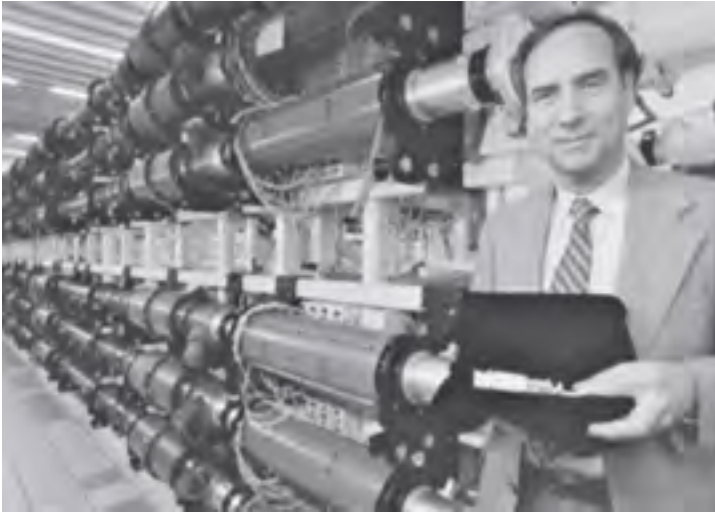
Figure 6 | En 1980 à Livermore, Theodore Maiman posait avec les éléments de son premier laser devant 6 chaînes du laser SHIVA qui en comportait 20 pour une énergie totale par impulsion de 10 kilojoules en une nanoseconde. On est passé de l'un à l'autre en moins de vingt ans, SHIVA ayant été inauguré en 1977. © Droits réservés.
