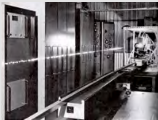
Figure 16 | Alignement de boules de plasmas obtenu en concentrant la lumière d'un laser à verre au néodyme au moyen d'une lentille de très longue focale. © Compagnie Générale d'Électricité.
