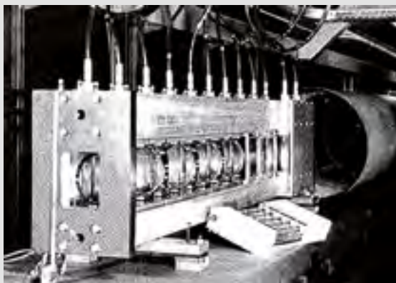
Figure 28 | Première réalisation d'un amplificateur à disques à Livermore. © Droits réservés.
