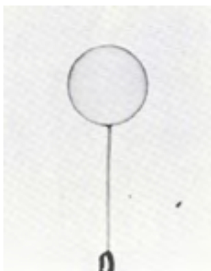
Figure 57 | Microballon monté sur son piédestal dans la chambre d'interaction. Son diamètre est d'environ 0,1 mm. L'épaisseur de la paroi est d'un micromètre. © KMS-Fusion.
